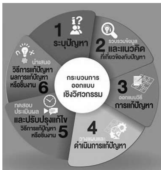
ภาพ 3 วงจรกระบวนการออกแบบเชิงวิศวกรรมโดย National Research Council
