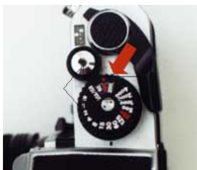
ภาพที่ 13 การตั้งค่าความไวแสงของฟิล์มที่ตัวกล้อง
