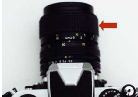
ภาพที่ 14 แสดงวงแหวนปรับระยะชัดพร้อมทั้งตัวเลขบอกระยะชัด
